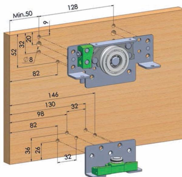
6.13 - SGM-04-1 Metalni mehanizam i SFT-003 usporivač za klizna vrata
