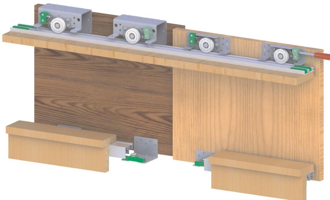
**SGM-04-1** Metalni mehanizam, za klizna vrata maksimalne nosivosti do 80kg. Mehanizam se koristi za pomicanje dvoje vrata, koja su kompatibilna visini plakara. Optimalna debljina vrata je od 18mm do 22mm. Bočna ivica korpusa kod spoljnih vrata treba da je za 35mm duža od bočne ivice korpusa unutrašnjih vrata. Rukohvate i ukrutne profile pogledajte na zadnjoj stranici kataloga.
