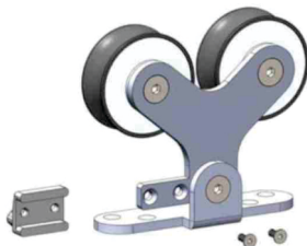
Prikaz montaže prihvatnika za usporivač na gornji klizač
